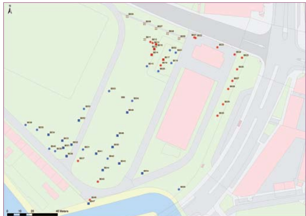
Afb. 10 De locatie van de boorpunten met nummers aangegeven in huidige topografie. Rode ster: boring gestaakt vanwege puin/baksteen, rood vierkant: boring met mogelijke constructie-element, licht roze vierkant met kruis: boring waarin dekzandbodem werd aangetroffen, blauw vierkant: boring met zand en kleilagen, blauwe ster: boring met rivierzand zonder kleiafzettingen of met kleiafzetting dieper dan 0.80-nap.
