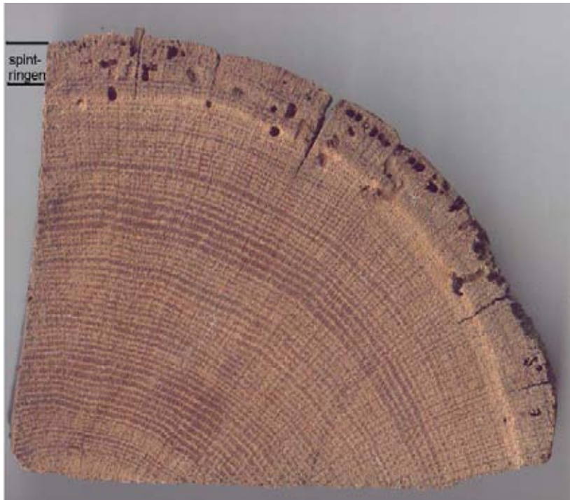
Figuur 116: Doorsnede van een eikenhouten strijkbalk (BR005A) gebruikt bij de herbouw van het huis Visserstraat 31; het bouwhout is dendrochronologisch gedateerd rond 1489.
