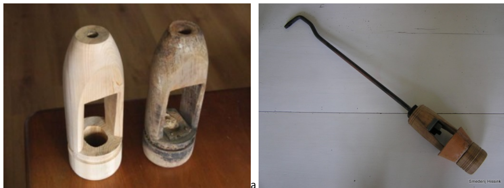
Afb 12a) antieke (rechts) en gerestaureerde pompzuiger; b) pompzuiger met ijzeren trekstang (Foto's: internet).
