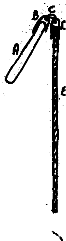
Dorsvlegel: A. Sieger. B. Leren lus. C. Leren verbindingsveters. D. Ijzeren beugel. E. Steel.
